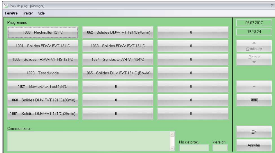
Figure 8 Fenêtre de sélection avec le choix des programmes de stérilisation
